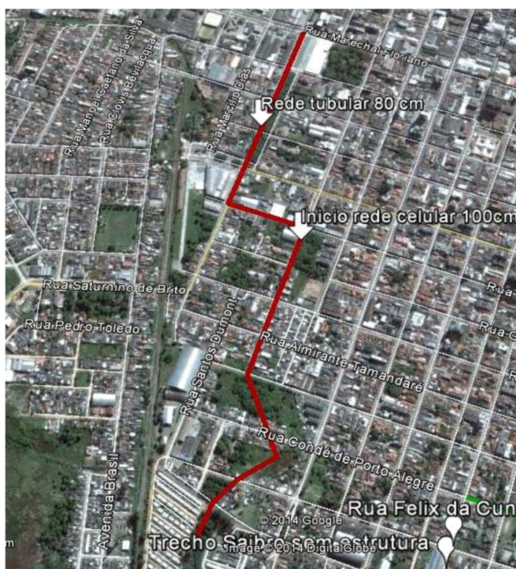
Figura 13 – Croqui das redes de drenagem da região da Av. Saldanha Marinho
